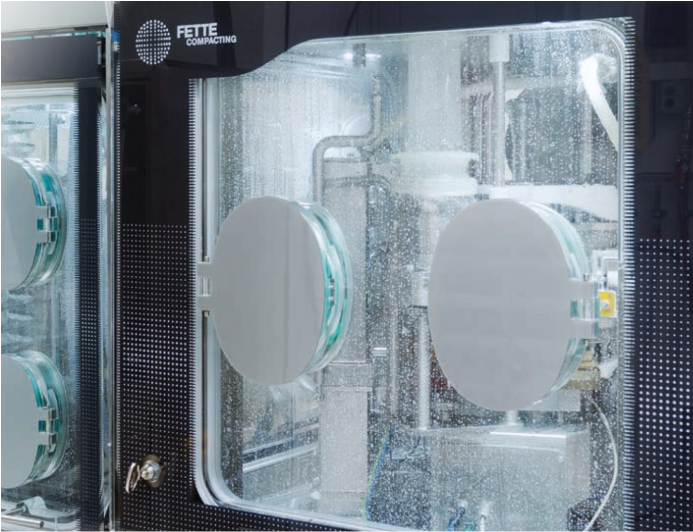
Ein waschbares Containment-System erleichtert Reinigungsprozesse, schützt die Bediener und beugt Kreuzkontamination vor.
