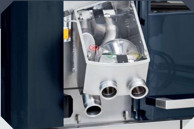
Reibungsloser Fluss: innovativer Tablettenablauf der F20i.
